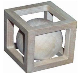
3D-Arbeiten lassen sich auch mit dem MOVIX-System ausführen. Allerdings ist die A4-Maschine eher für 2 bis 2,5D-Arbeiten vorgesehen, aber prinzipiell ist das System 3D-fähig. Ein Beispiel ist das Demostück "Die Kugel im Käfig", die mit der PT-360 gefräst wurde (siehe Bild).
